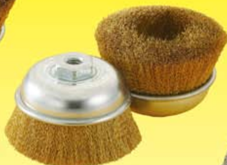
■PG-0011 (真鍮) 真鍮・銅などの研磨、サビ・バリ落とし木製品の木目出し作業などに線の柔らかい0.18mmの真鍮線をよった、ソフトな当たりのワイヤーブラシです。
