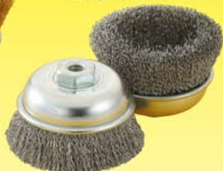
■PG-0013 (ステンレス) ステンレス・鉄・非鉄金属などのサビ・バリ・ペンキ落し、下地研磨に耐酸・耐アルカリ・耐熱性に優れたステンレス線をよった、錆にくく粘りのあるワイヤーブラシです。
