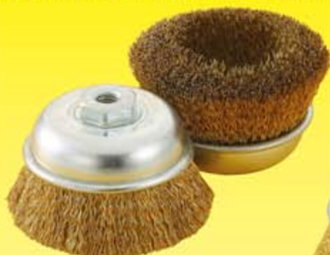
■PG-0010 (真鍮メッキ) 鉄・非鉄金属・ゴム・合成樹脂などのサビ・バリ・ペンキ落し、下地研磨に硬鋼線に真鍮メッキをほどこし線材をよったサビ・折れの少ないワイヤーブラシです。
